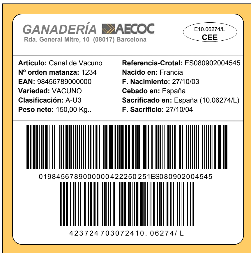
Etiqueta en la que faltan los paréntesis en el texto que figura bajo las barras
